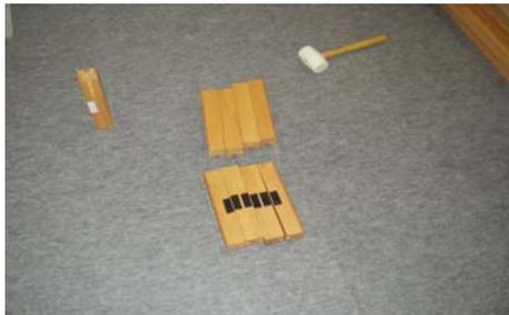
角の柱(二方柱)とその間の柱(三方柱)を事前に揃えておけば手間が省けます
